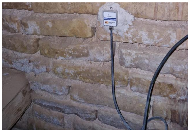
Қожа Ахмет Ясауи кесенесінің бөлмелеріне температуралық-ылғалдылық режимін күнделікті бақылауға арналған Германиялық заманауи үлгідегі Testo-625 термогигрометр аппараттары орнатылды
