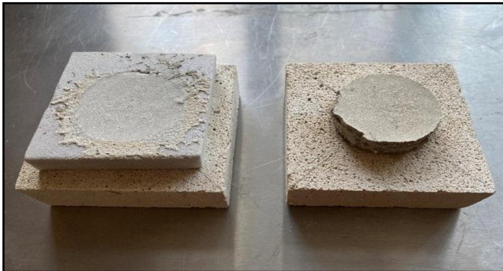
Образцы для испытания сцепления с раствором.
