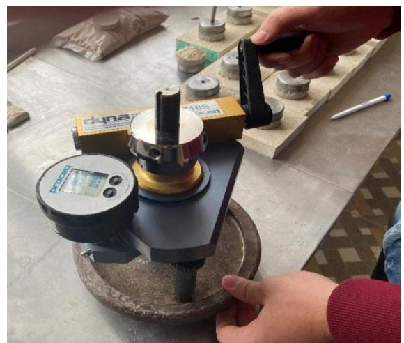
Образцы для испытания сцепления с раствором.
