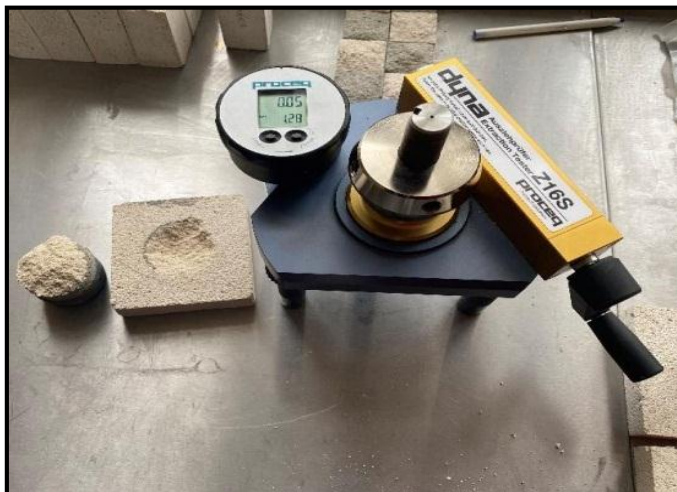
Образцы для испытания сцепления с раствором.
